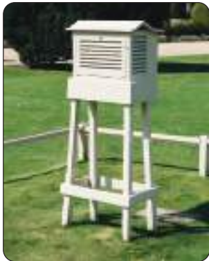
Figure (14) Abri Stevenson (abri de station météorologique)
